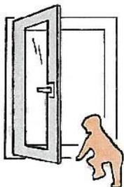
Wo Kleinkinder oder Personen mit geistiger Behinderung Zugang zum Fenster haben, ist der Flügel gegen Aufdrehen zu sichern, z. B. mit Dreh Sperre oder abschließbarem Bedienungsgriff.
