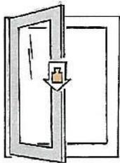
Der Fensterflügel darf nicht mit zusätzlichem Gewicht belastet werden.
